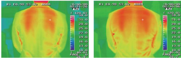
▶ジャケット表面温度のサーモグラフィー検証結果。(右がエアクール、左が従来品)
